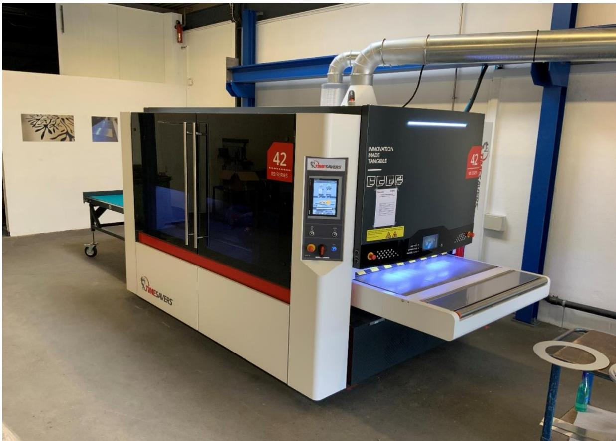
Cette machine rotative multi directionnelle à brosses et bandes abrasives permet l'ébavurage et la finition uniforme de pièces plates sur toutes les faces.
