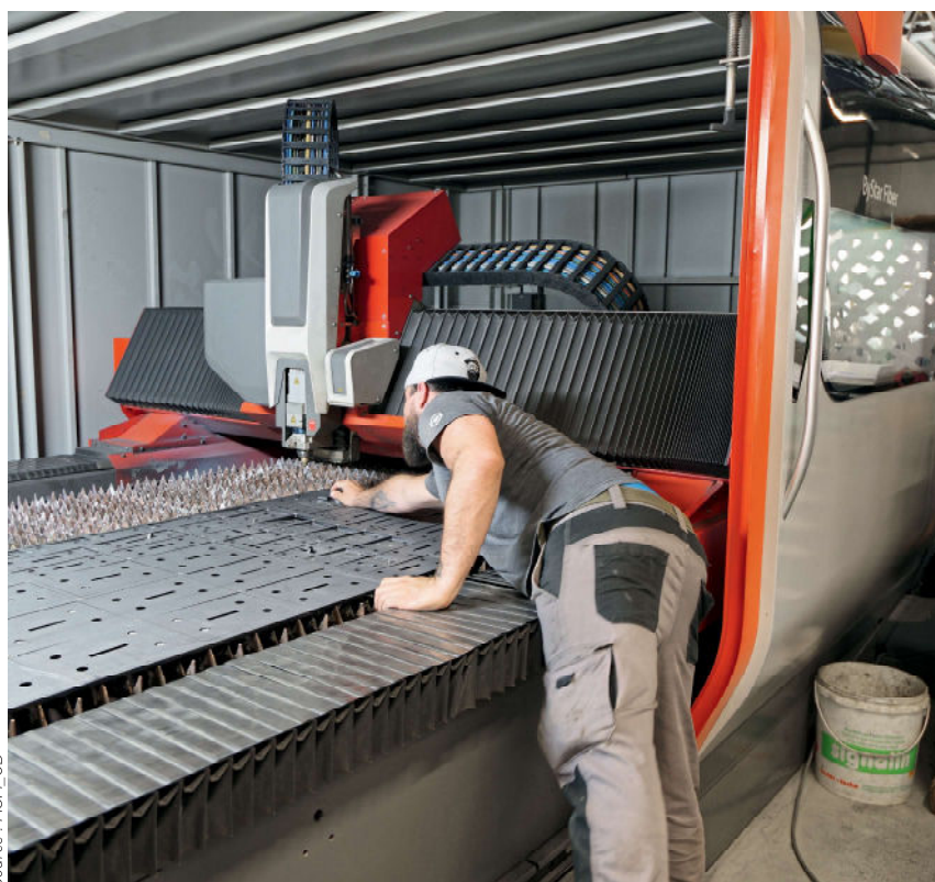
Le laser fibre de 20KW permet des découpes extrêmement rapides avec un haut degré d'automatisation.
