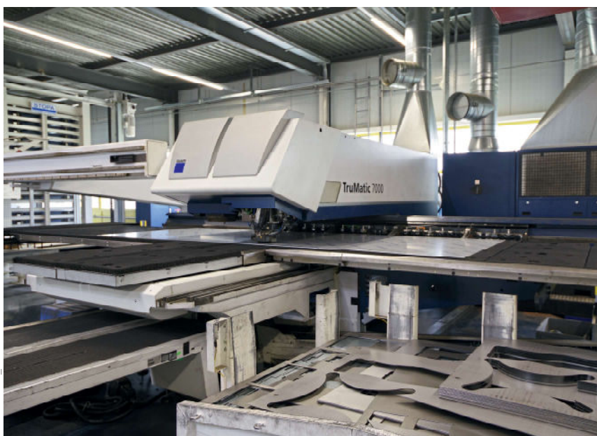
Ultra polyvalente, la TruMatic 7000 combine les avantages de l'usinage par poinçonnage, la découpe laser, le pliage et les opérations de taraudage et d'emboutissage.
