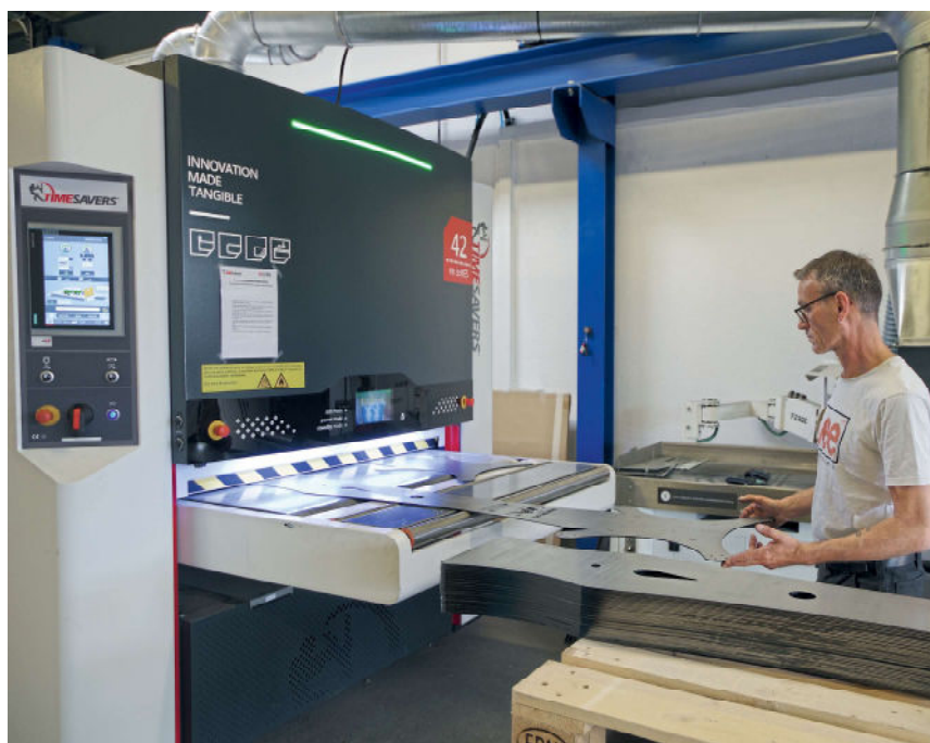
La nouvelle machine de brosse TimeSavers permet d'obtenir des pièces parfaitement propres sans aucunes arêtes vives.
